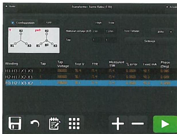
04 Oberfläche für die Übersetzungsverhältnisprüfung
